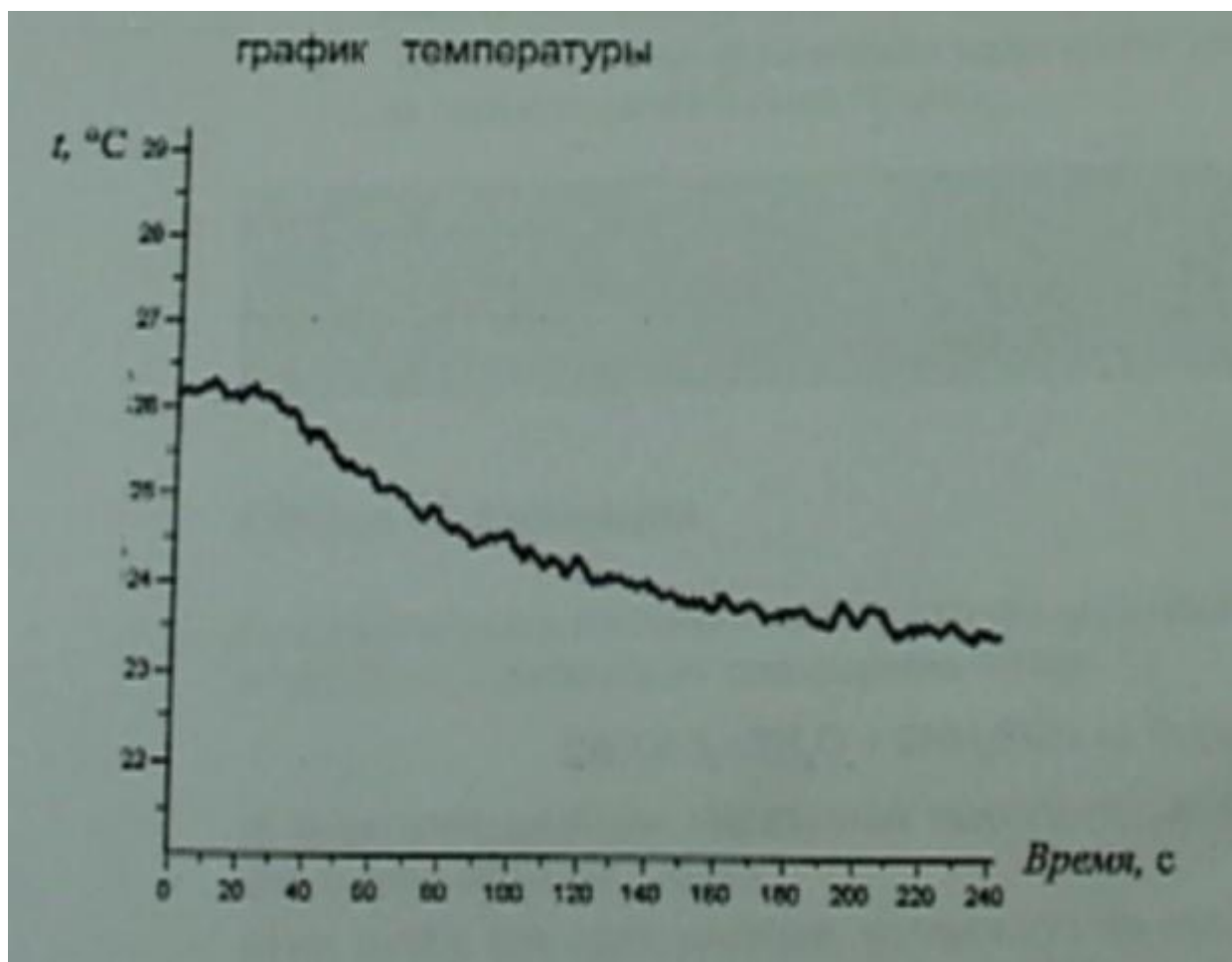
Рис.1. Примерный вид графика температуры при проведении лабораторной работы № 3 «Эндотермические реакции. Растворение безводного нитрата аммония в воде».
