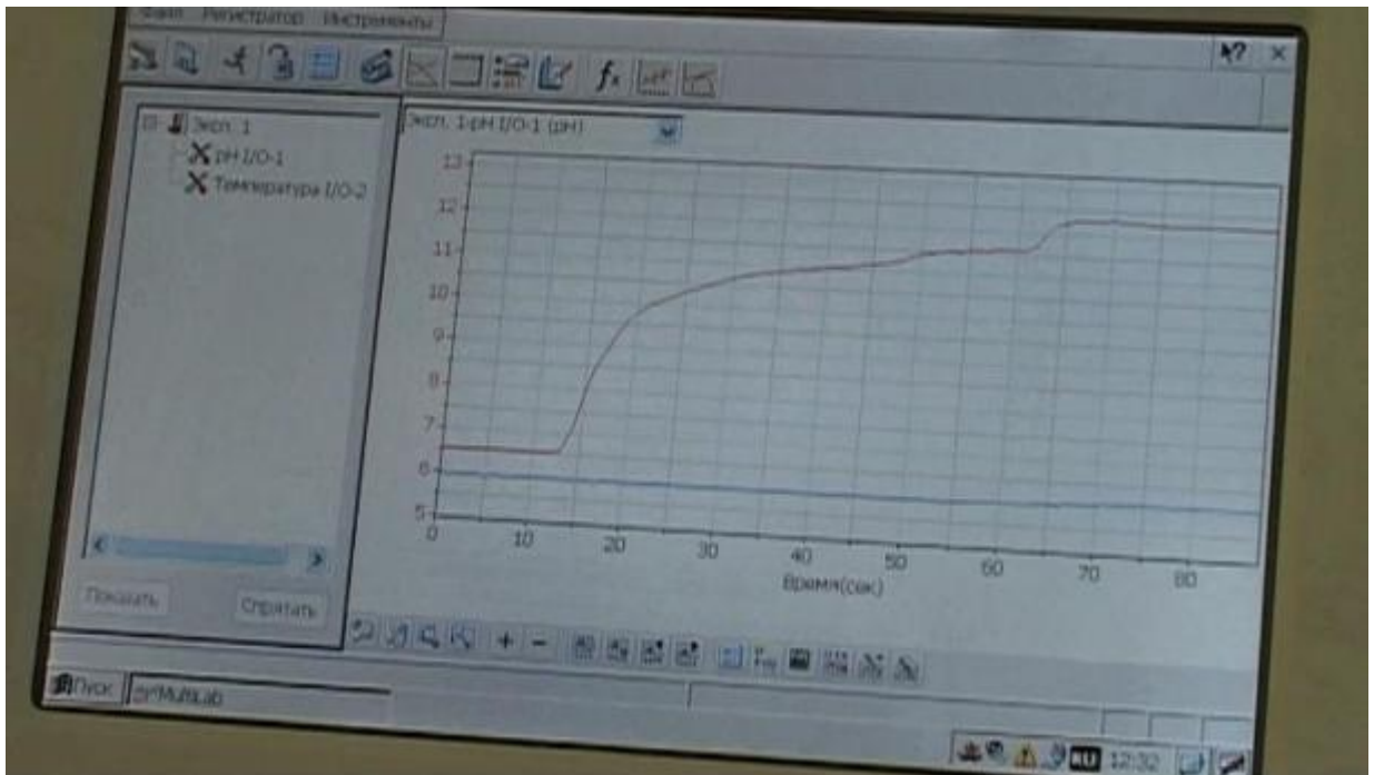
Рис.2. Примерный график зависимости температуры и pH от времени.
