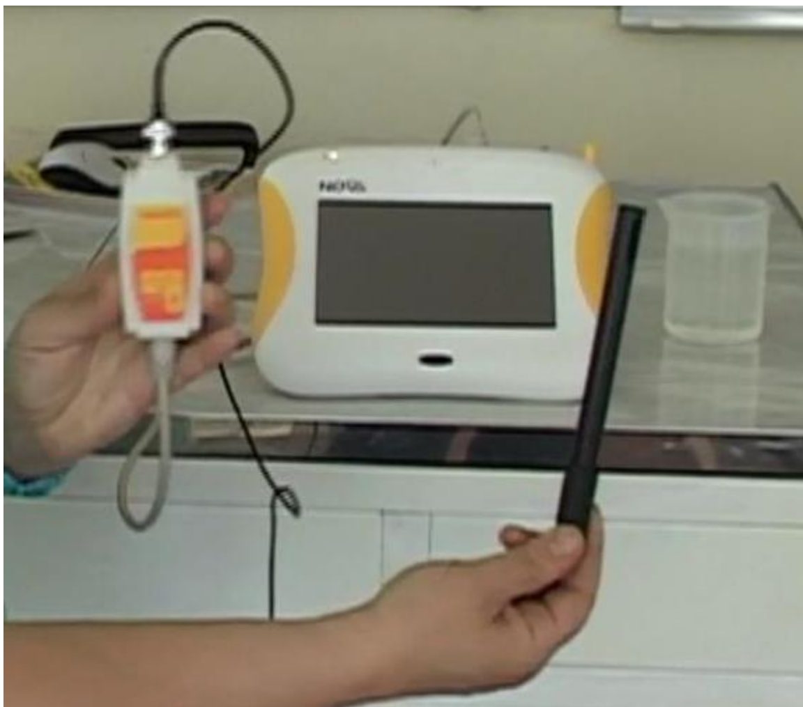
Рис.1. Датчик электропроводимости для проведения лабораторной работы по химии № 5 «Электролиты и неэлектролиты».
