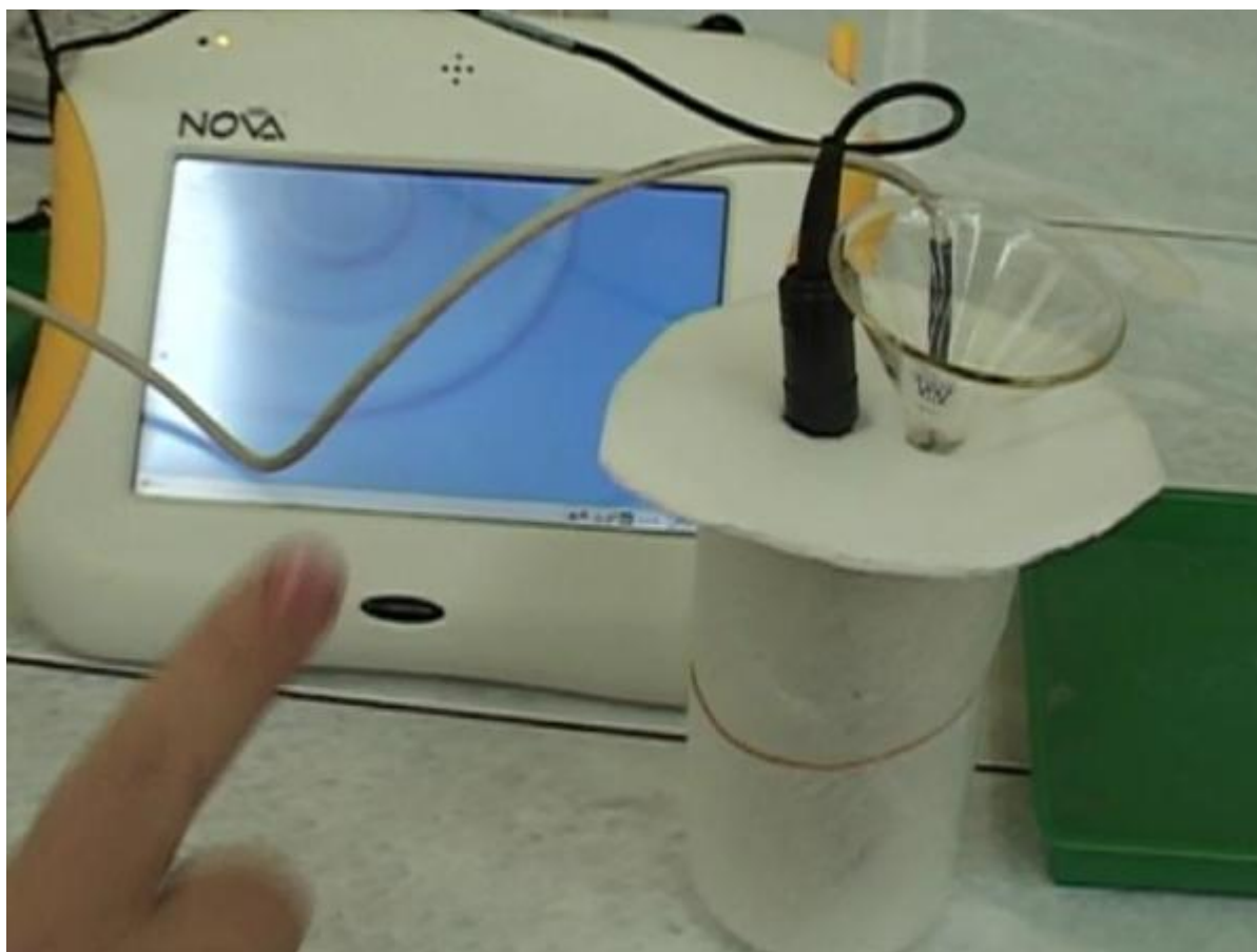
Рис.1. Монтаж установки при проведении лабораторной работы № 2 «Экзотермический реакции. Растворение безводного гидроксида натрия в воде».
